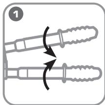
**1** Расфиксируйте рукоятки, повернув их вокруг оси.
